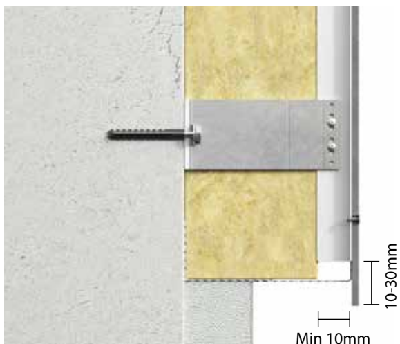
Függőleges nézet: lábázat képzés
