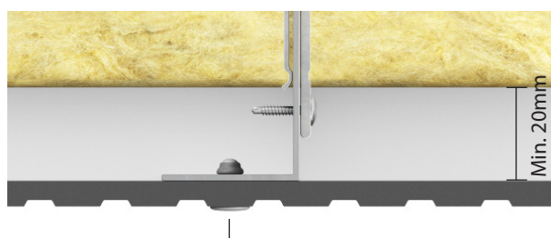
2-es ábra. Cembrit Patina Inline rögzítése L profilra
