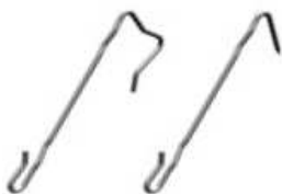
Palakampó \varnothing 3 mm rozsdamentes acélból, 5 mm-es fugaszélességhez való könyökkel
