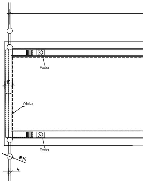
DETAILANSICHT | PLATTENSCHNITTE VERTIKAL & HORIZONTAL
